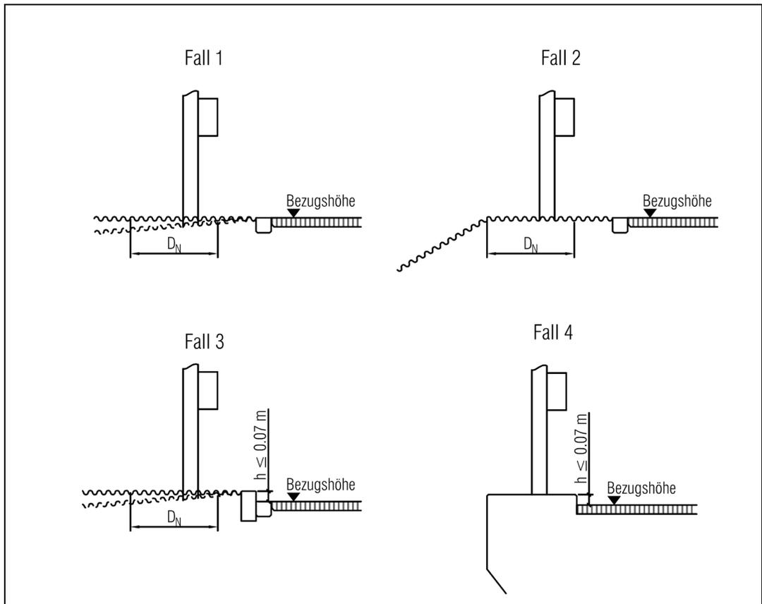
Abb. 6.1 Positionen und Bezugshöhen System 4211 (Anwendung, siehe Ziffer 6.2).
