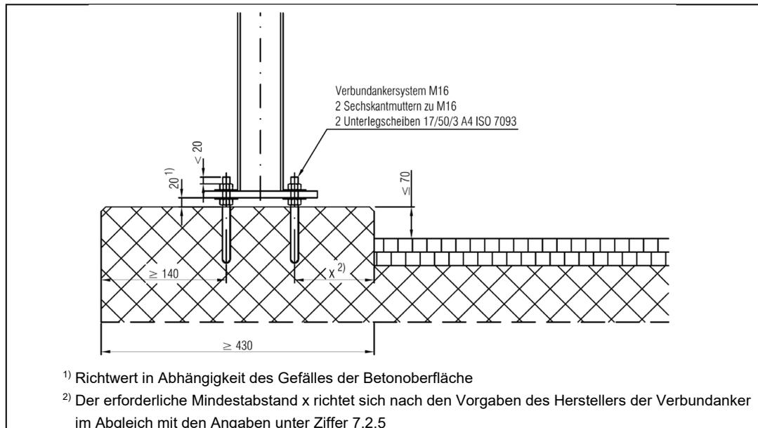
Abb. 7.2 Pfosten mit Fussplatte und Verbundanker auf Bauwerk.
