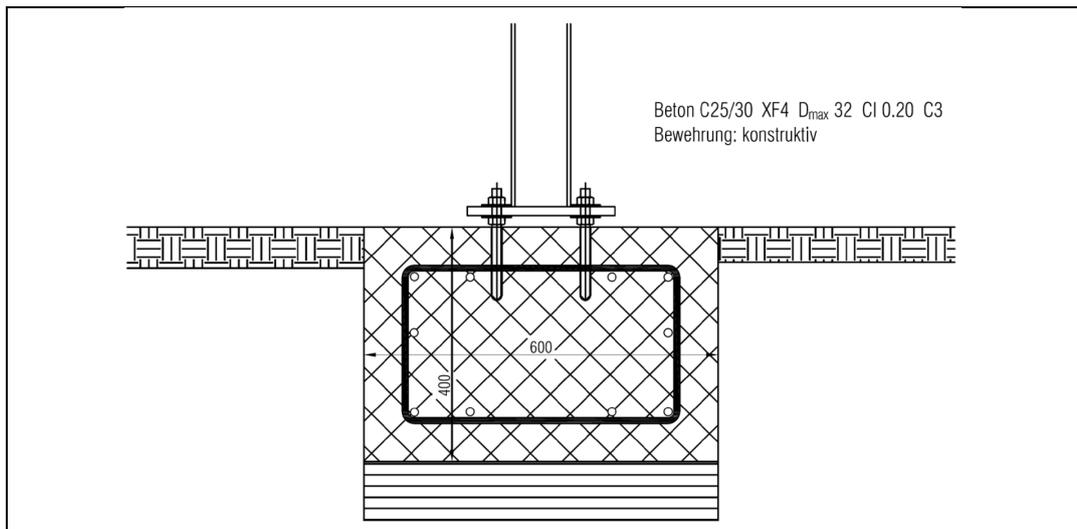
Abb. 7.3 Streifenfundament System mit Pfosten IPE 100.
