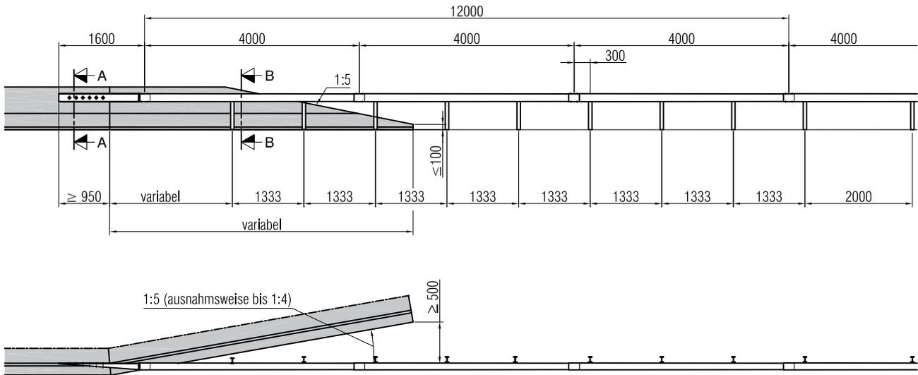
Bei mauernahen Pfosten soll das Betonfundament der Leitmauer bis OK Belag reichen, so dass Pfosten mit Fussplatte eingesetzt werden können.
